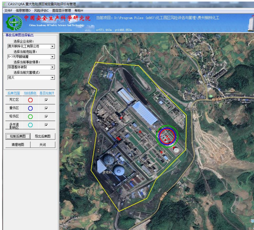
图 5.8-8 污甲醇储罐事故危害范围示意图
