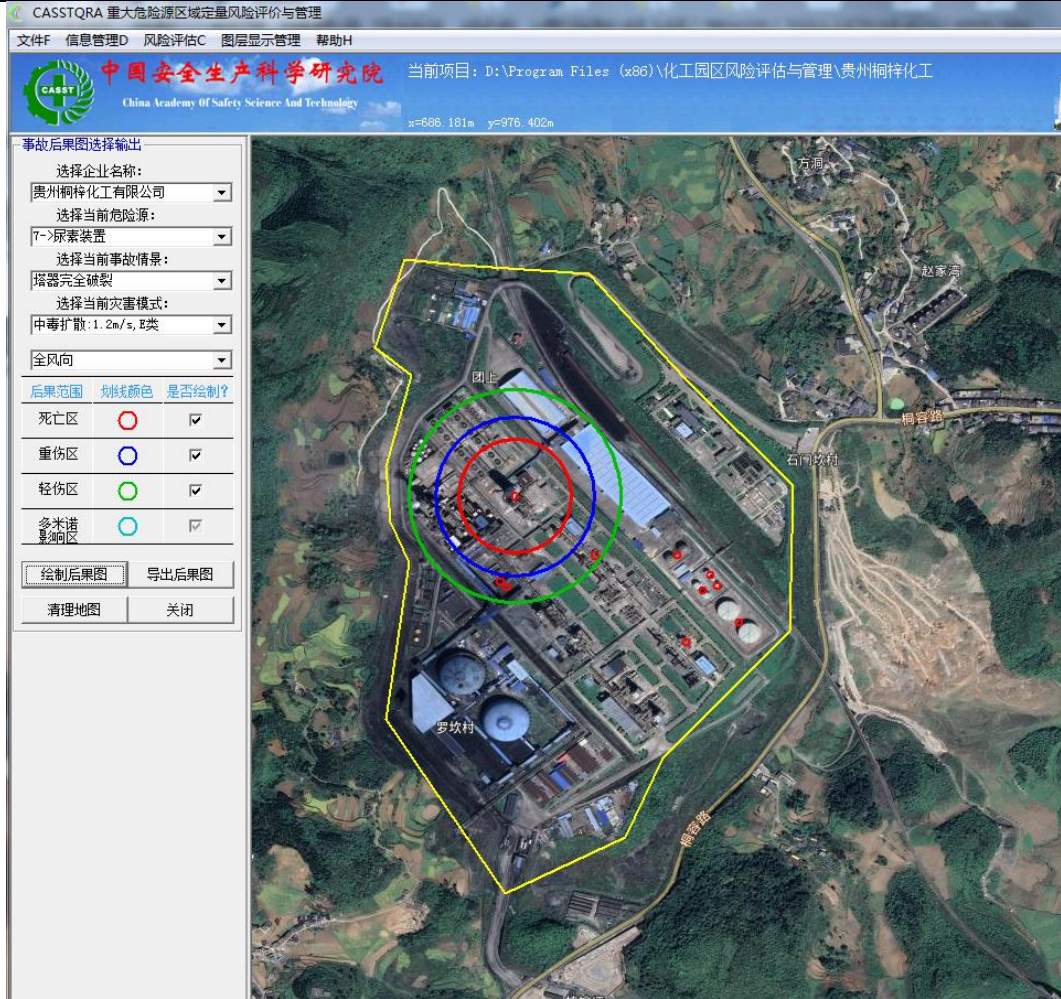
图 5.8.4 尿素装置反应塔完全破裂事故危害范围示意图
